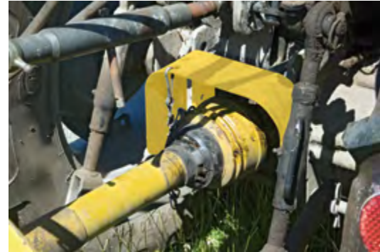
Abb. 41 Gelenkwellen sind bis über die Kreuzgelenke zu verkleiden. Der Schutz ist gegen Mitdrehen zu sichern.
