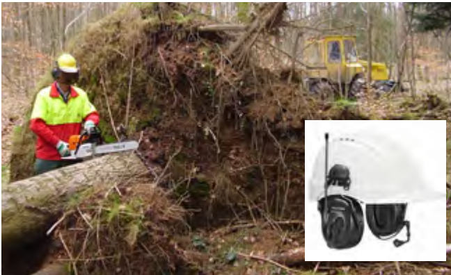
Abb. 104 Abstocken mit seilgesichertem Wurzelteller - Sägeführer mit Helmfunk
