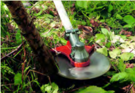
Abb. 28 Kreissägeblatt mit Schutz
