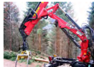
⑧ Lasthebeeinrichtung nicht Beachtung der Be- lastungsgrenzen führt zu erhöhter Umsturzgefahr
