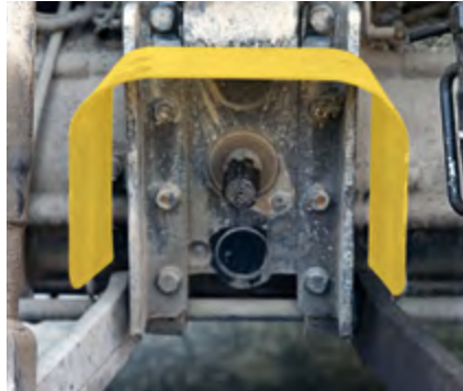
Abb. 40 Zapfwellen müssen durch ein Schutzschild mindestens von oben und von den Seiten gesichert sein. Es muss bis über die Mitte des Kreuzgelenkes der anschließenden Gelenkwelle reichen.
