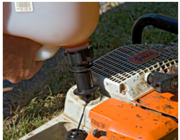
Abb. 24 Betanken mit Sicherheits-Einfüllstutzen
