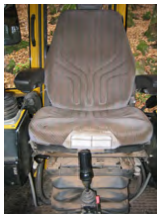
⑨ Fahrsitz schwingungsgedämpft zur Vermeidung von Ge- sundheitsschäden durch Schwingungen und Stöße
