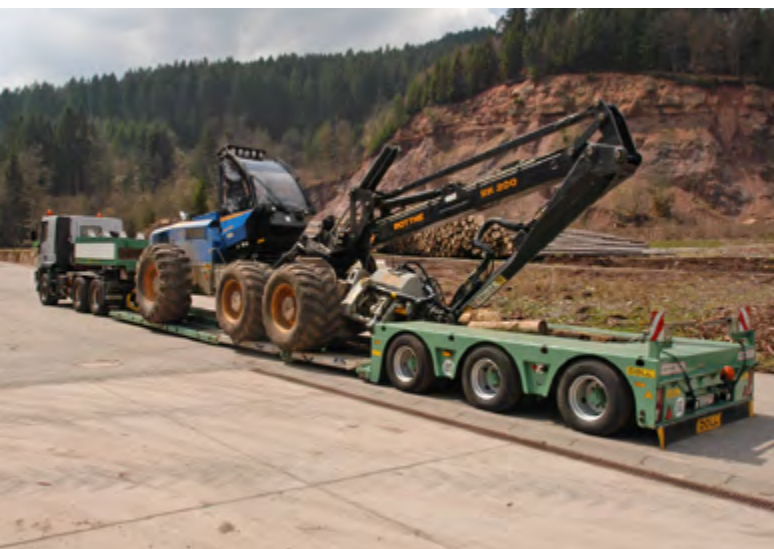
Abb. 51 Sicherung eines Harvesters auf einem Transportfahrzeug
