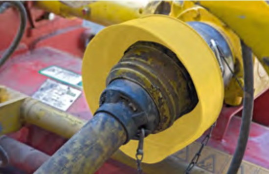
Abb. 39 Der maschinenseitige Gelenkwellenanschluss ist zu verkleiden. Der Schutz muss bis über die Mitte des Kreuzgelenkes der anschließenden Gelenkwelle reichen.
