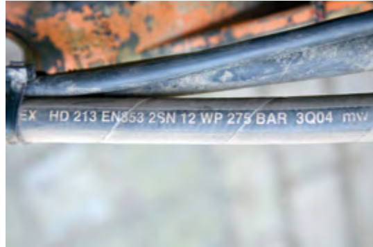
Abb. 43 Beschriftung auf der Schlauchleitung
