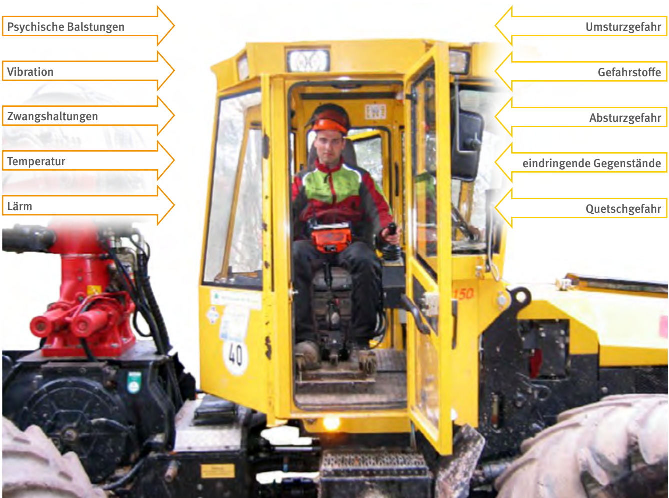
Abb. 2 Belastungen und Gefahren für den Maschinenführer
