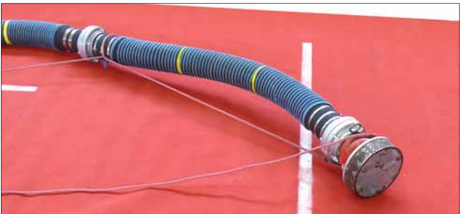
Abb. 36: Richtiges Ablegen des Saugkorbes jenseits der Wasserlatte.
