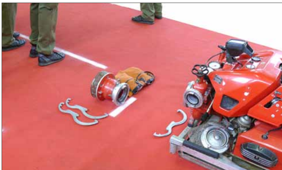
Abb. 7: Auflegen der Bewerbungsgeräte Schlüssel, Saugkorb und Leinenbeutel.
