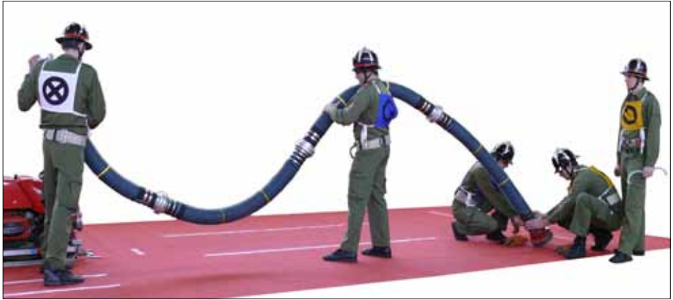
Abb. 31: Hochheben und Aufstellen der fertig gekuppelten Saugschlauchleitung.
